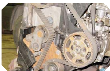
Zobati jermen za pogon odmične gredi in visokotlačne črpalke pri avtomobilskem motorju
