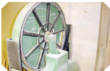
Vrteča os pri tračni žagi
