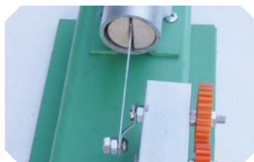
Ročični mehanizem v povezavi z batom
