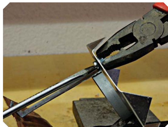
Vijačenje podstavka in nosilca skodelice
