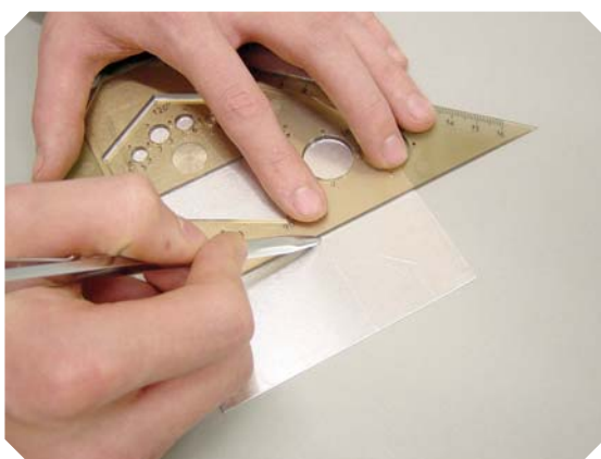
Zarisanje na pocinkano in aluminijasto pločevino
